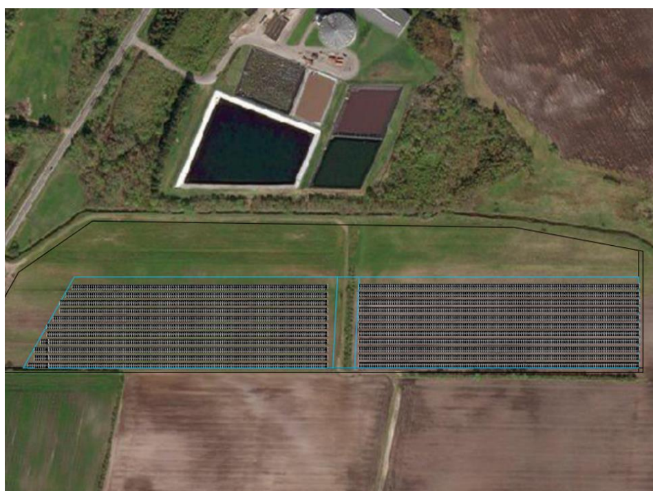
Figur 4: Solcelleanlæg på 7,3 ha med effekt på 7,88 MWp.
